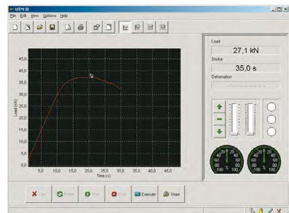
Gráfico de un ensayo de compresión en cemento
