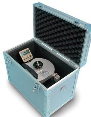
Compacto. Ligero, de uso en cualquier lugar, este equipo de adherencia Pull-Off está equipado con una célula de carga y una pantalla digital de alta resolución, por lo que es adecuado para mediciones desde baja carga hasta 16kN, garantizando una amplia gama de trabajo, ideal para un gran número de aplicaciones y materiales. La fuerza de tracción directa se aplica al girar la mani-vela de mano.
