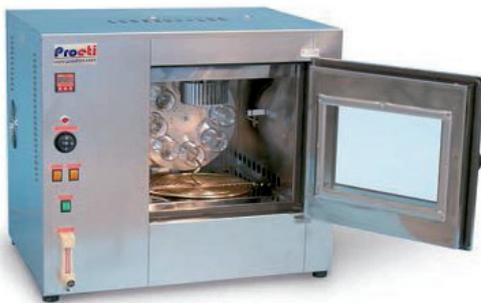
**EFFECTO DEL CALOR Y EL AIRE SOBRE UNA PELICULA FINA DE ASFALTO EN MOVIMIENTO. MÉTODO RTFOT**
