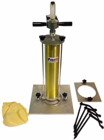
Мембранный определитель объема с потенциалом 1600 мл. ASTM D2167 - AASHTO T205 - CNR N° 22
